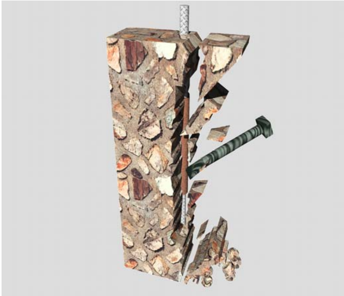
Fig.12. Picado de hormigón y del acero mediante medios mecánicos. Cada vez que el martillo golpea la armadura, se produce un quebranto en la adherencia entre ésta y el hormigón circundante. Además el puntero induce una fisuración en el hormigón que reduce considerablemente su capacidad de soporte para el mortero de reparación.
