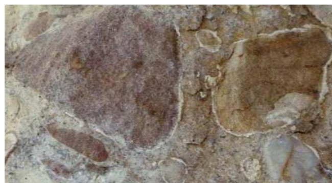
Figura 4. Halos blanquecinos en el contorno de un árido. Fotografía tomada con una lente ordinaria
