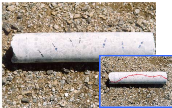
Figura 13. Testigo extraído \phi 100MM de un hormigón inyectado. El monolitismo se ha recuperado. En la segunda foto se ha resaltado la posición de la fisura totalmente rellena de resina. Los ensayos a rotura sobre estas probetas ofrecen unos resultados idénticos a los del hormigón no figurado.
